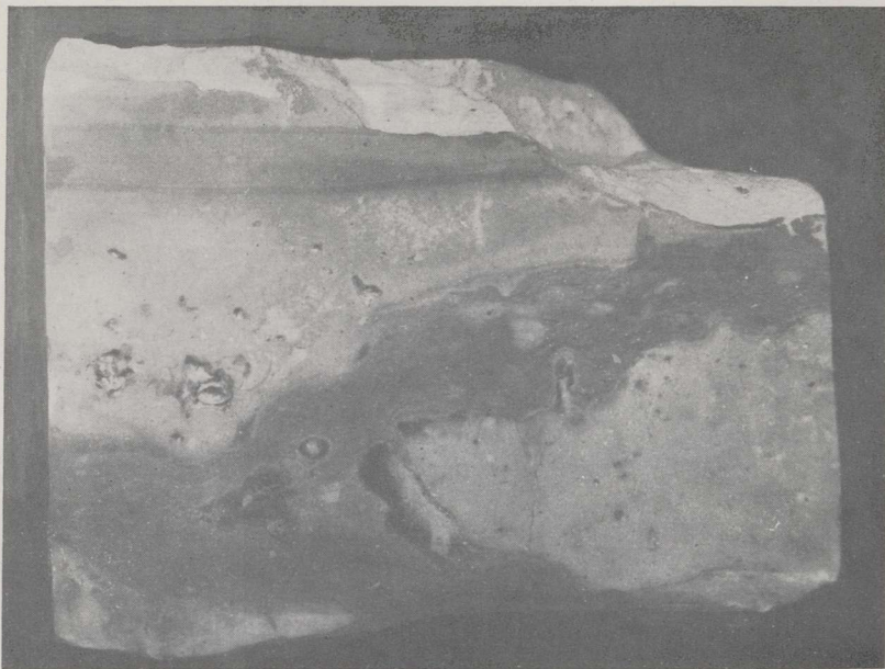
Фото 4. Обломки светлого мелкокристаллического доломита в более темном, мергелистом мелкокристаллическом доломите (образец из скв. Эйнамаа, глубина 37,23—37,30 м).
