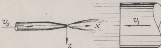
Рис. 1. Схема круглой струи, развивающейся в начальном участке встречной струи большого размера.
