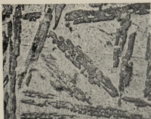
б — клинкер 12-2, содержащий 39% алита;
