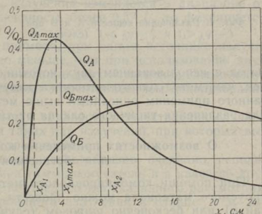
Как видно из фиг. 3, значения функции  $Q_A$  превосходят любые значения функции  $Q_B$  при величине аргумента  $x_{A1} < x < x_{A2}$ . Следовательно, по данной схеме эти вещества можно различить лишь в том случае, если размеры кусков изменяются в интервале  $x_{A1} < x < x_{A2}$ .
