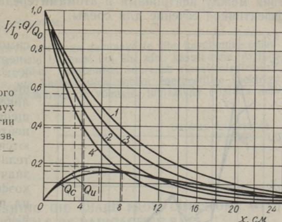
Фиг. 5. Сравнение метода одного источника излучения с методом двух источников излучения при энергии излучения: для сланца 1 — 1,3 Мэв, 2 — 0,5 Мэв и для известняка 3 — 1,3 Мэв, 4 — 0,5 Мэв.
