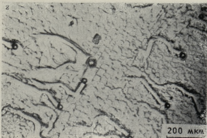
Рис. 2. Поверхность подложки после термического травления: а — бездефектная поверхность со стопорами, б — следы нарушенного слоя, в — следы поверхностных загрязнений, г — следы движения капелек галлия. ОМ.
