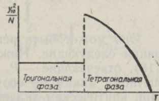
Рис. 4. Зависимость квадрата величины искажения решетки от температуры при реализации двух низкосимметричных фаз: тетрагональной и тригональной.
