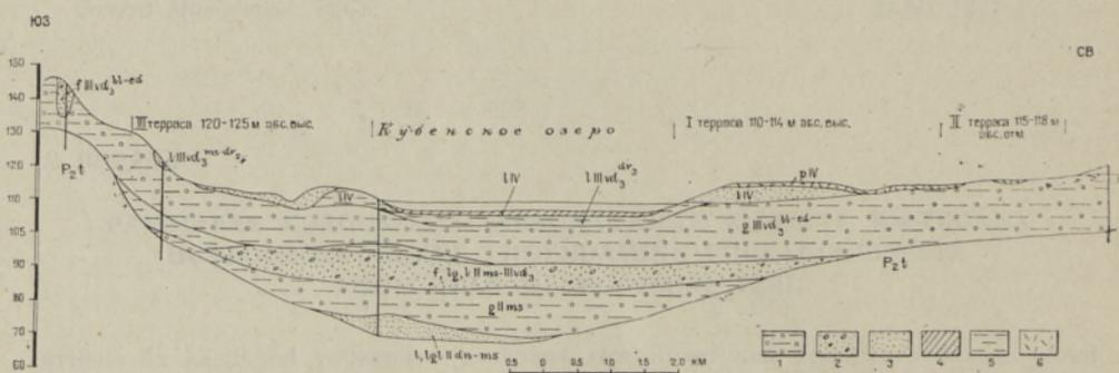
Рис. 1. Геологический разрез через Кубенское озеро по линии д. Мишаково — д. Дор:
