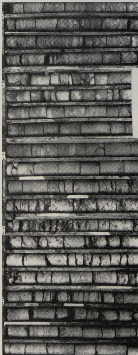
Разрез буровой скважины К-16. (Стрелками указаны границы песчаной линзы.)
