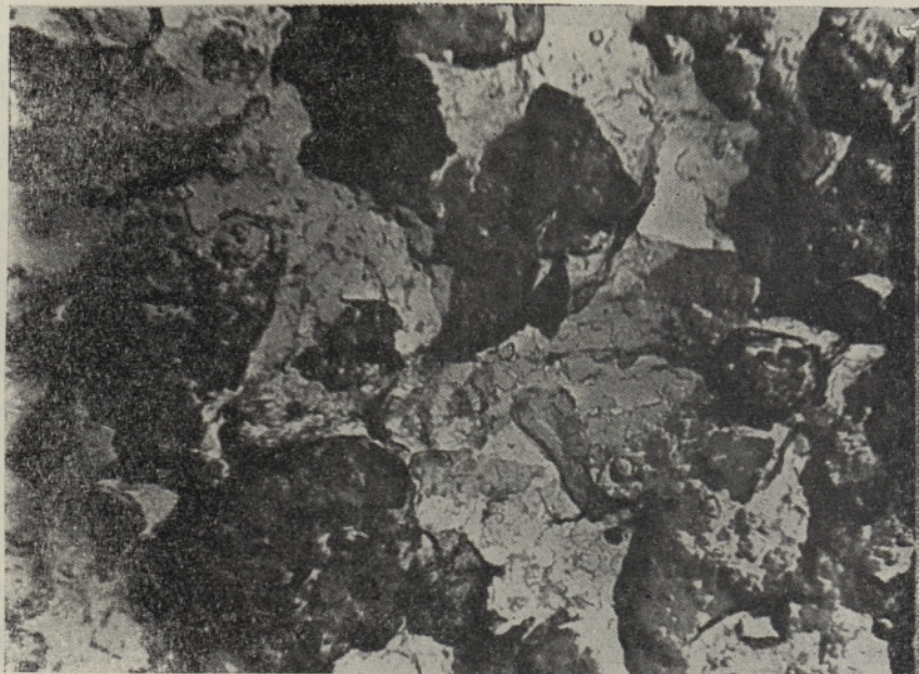
Рис. 4. Реплик с поверхности ориентированного препарата; видны неправильные формы частиц монтмориллонит-хлорита.
