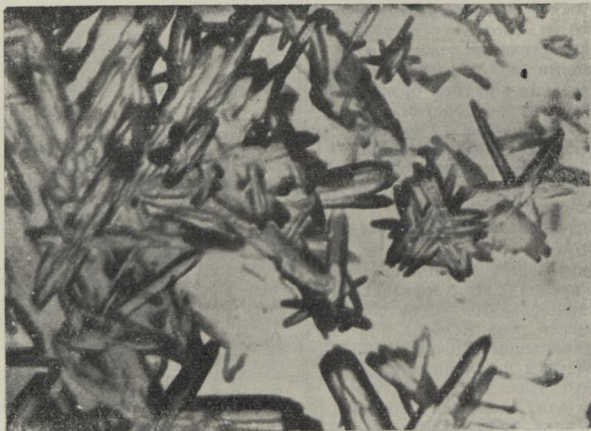
Рис. 3. Реплик с оскола глины; видны звездочки гетита.
