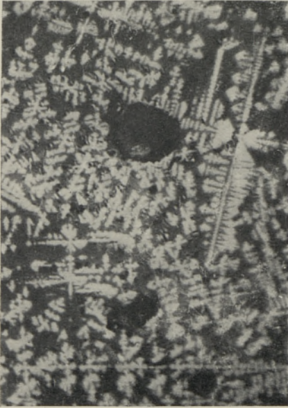
Рис. 3. Скелетные кристаллы магнетита в силикатном веществе. Черные пятна — поры. (Отраженный свет, увел. 800×).
