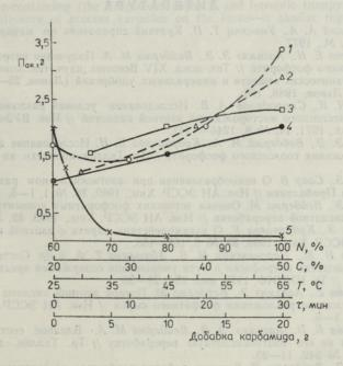
Зависимость потерь HNO $_3$  с газами ( $\Pi_{\rm ar}$ ) при азотнокислотном разложении 1000 г кингисеппского фосфорита от концентрации кислоты C (I), от температуры разложения T (I), от времени разложения T (I), от нормы кислоты I (I) и от количества добавки карбамида (I).
