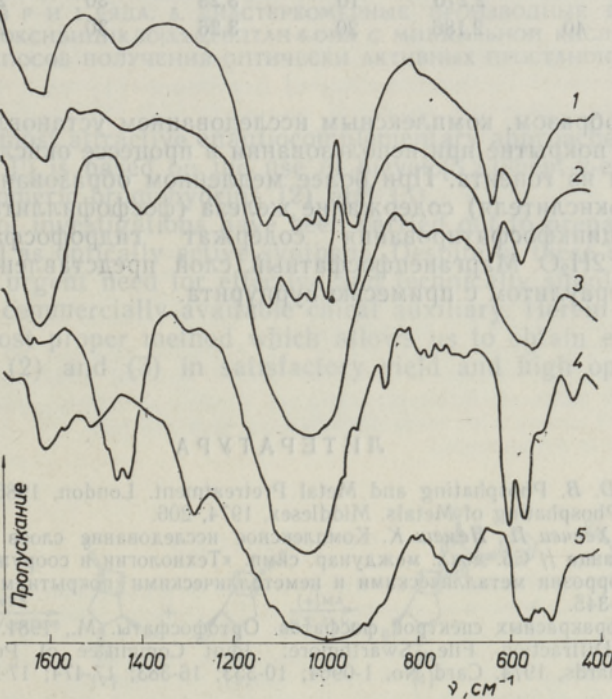
Рис. 2. ИК-спектры поглощения: 1 — цинкфосфатное покрытие (с NO 2 - ), 2 — цинкфосфатное покрытие (без окислителя), 3 — шлам цинкфосфатирования, 4 — марганецфосфатное покрытие, 5 — шлам марганецфосфатирования.
