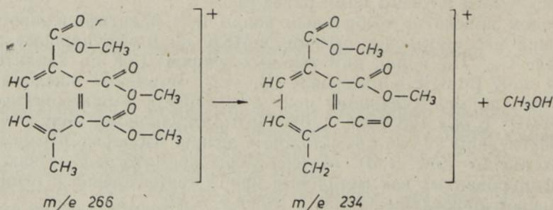
Пик 22 (рис. 1) соответствует триметилому эфиру дикарбоксифенилуксусной кислоты с молекулярной массой 266, т. е. с такой же, как и у триметилового эфира метилбензолтрикарбоновой кислоты, но
