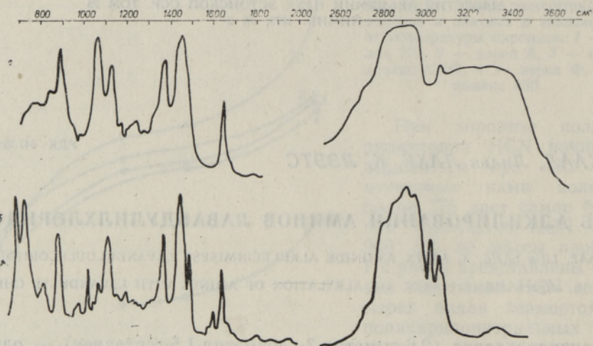
ИК-спектры лавандулилэтанолamina (а) и лавандулилбензиламина (б).
