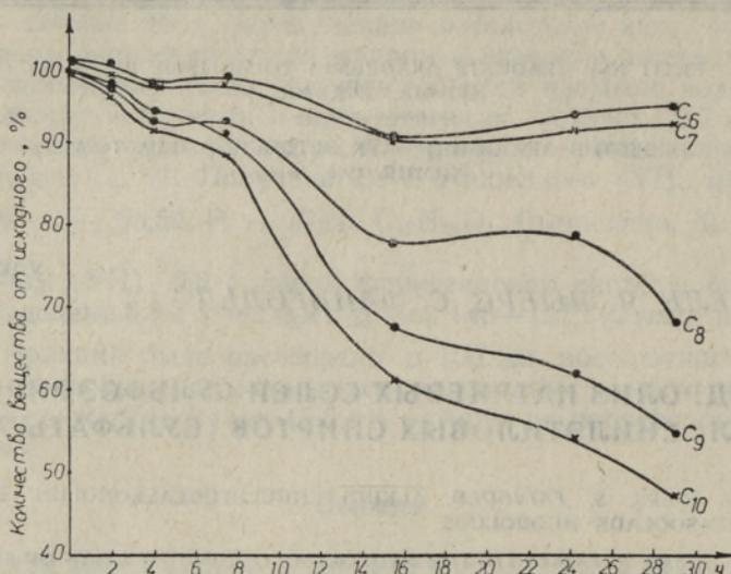
Рис. 1. Кислотный гидролиз сульфатов АФЭС при 80 °С.
