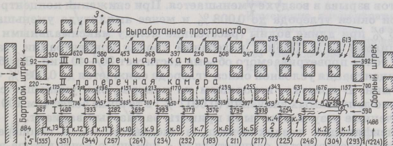
Рис. 1 Распределение воздуха в полублоке при работе вентилятора-эжектора. Цифры в скобках — распределение воздуха по I поперечной камере при обычном режиме проветривания; 1—5 — места отбора проб воздуха, 6 — вентилятор, Q_e = 298 \text{ м}^3/\text{мин}
