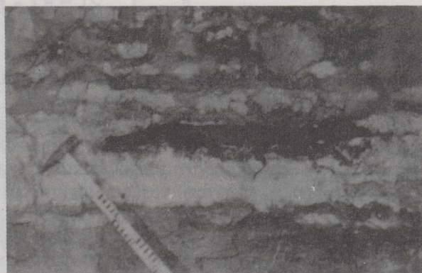
Рис. 3. Плоская линза твердого битума в прослое известняка "плита" промышленной пачки Ленинградского месторождения кукерсита (шахта №3). Светлый тон — известняк, серый — кукерсит, черный — асфальтит
