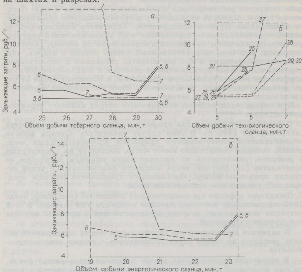
Зависимость показателя замыкающих затрат на товарный (а), технологический (б) и энергетический сланец (в) от объемов добычи. Условные обозначения: 5—7 — объем добычи технологического, 19—23 — энергетического и 25—30 — товарного сланца. Пунктирной линией отмечена область наличия решения; штрих-пунктирной линией показан средний уровень приведенных затрат на добычу товарного сланца по Прибалтийскому бассейну.
