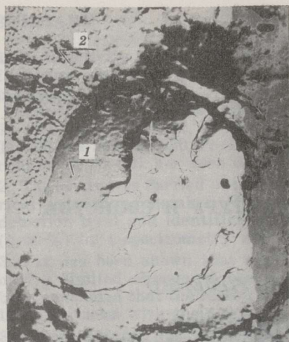
Рис. 1. Структура композиционного материала: 1 — частица золы, 2 — полимерная матрица
