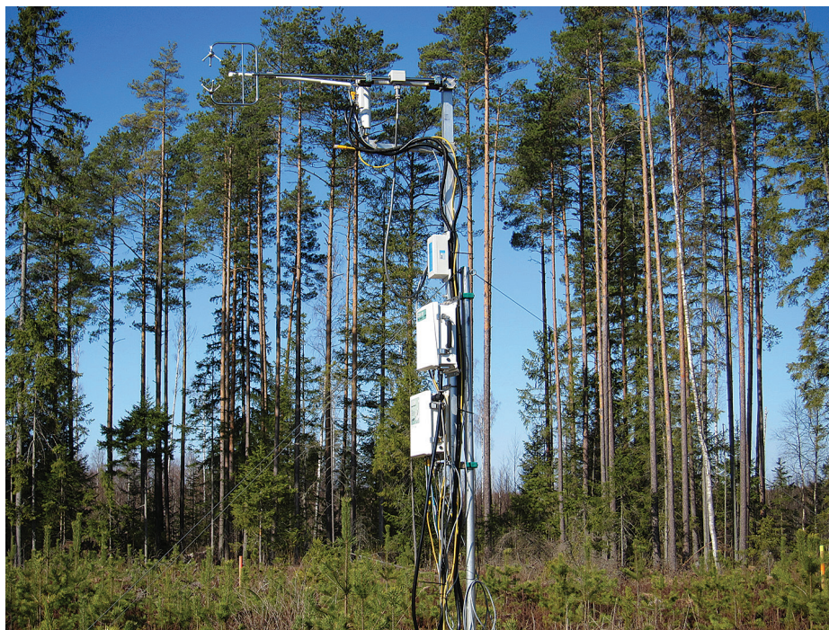
Joonis 5. Anemomeetri ja analüsaatoriga jaam männinoorendikus võimaldab mõõta gaasivahetust ökosüsteemi ja atmosfääri vahel.
