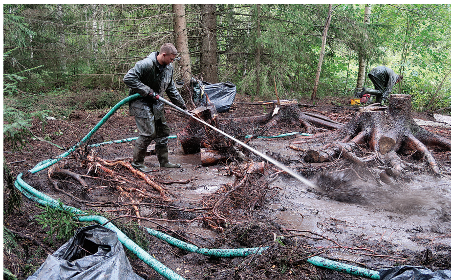
Joonis 1. Mudelpuude juurestike eraldamine mullast.
