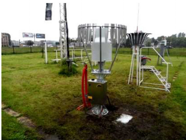
Fig. 1. General layout of the automatic OTT Pluvio2 gauge.
